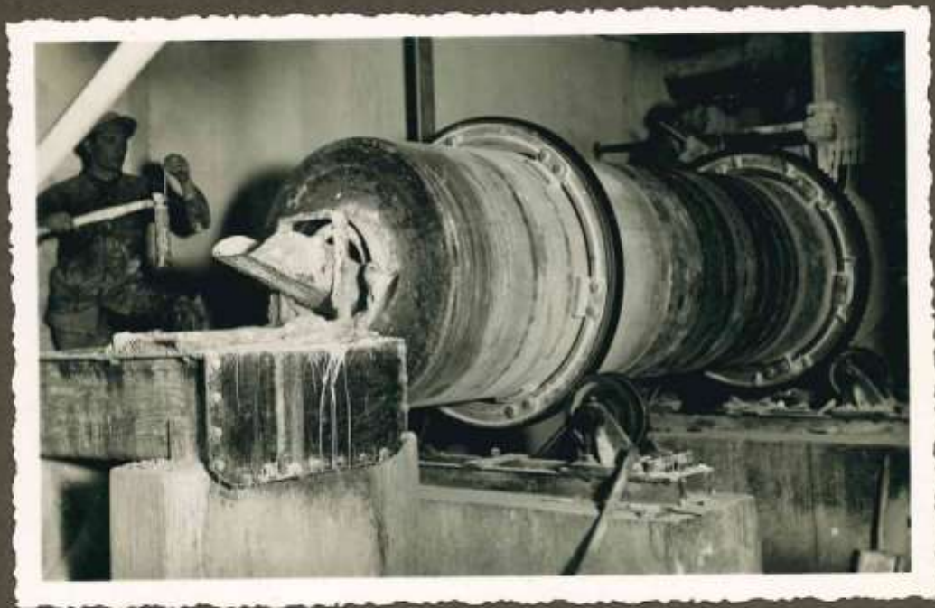
Μικα aparatā, veldzējot dedzinātos kaļķakmeņus, iegūst kaļķu pienu sulas tīrišanai.
