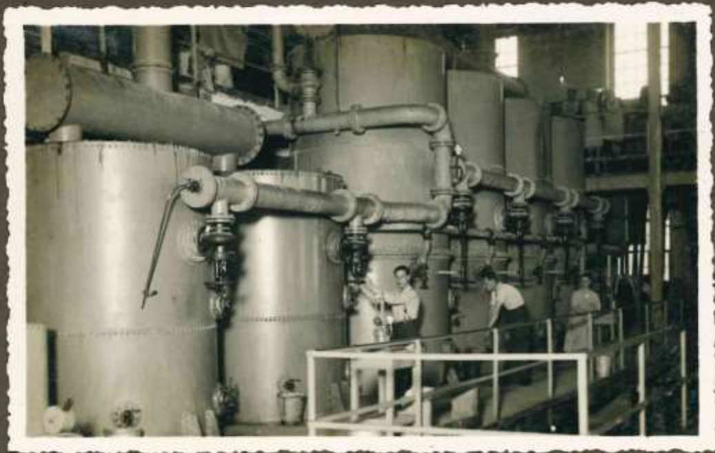
Saturatoros kaļķoto sulu apstrādā ar ogļskābo gāzi.
